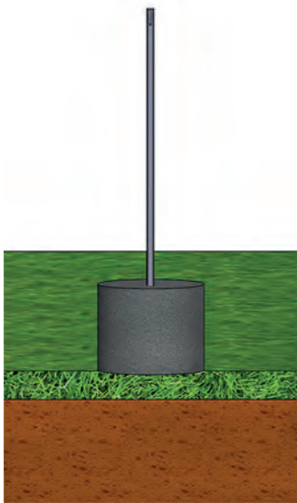
B1 (Balast wylewany)
